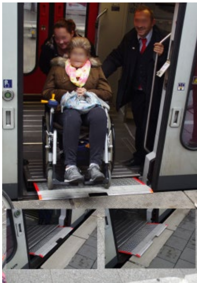
Met een ingebouwde elektrisch uitklapbare uitrijplaat is de toegang tot de trein veel gemakkelijker, zoals hier in Aken (2016!). Foto Rudy De Ceunynck
