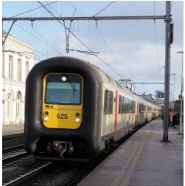
Te laag perron (55 cm) en minder toegankelijk materieel (Wetteren) Foto Rudy De Ceunynck
