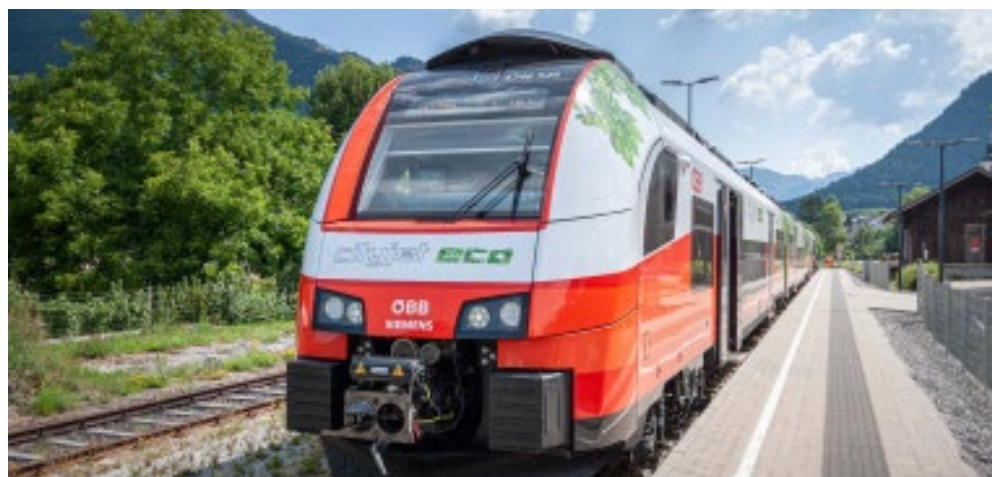
Siemens batterijtrein "Cityjet Eco" ontworpen op vraag van de Oostenrijkse spoorwegen: een bestaande Desiro doet dienst als prototype. De aanpassingen waren minimaal. © ÖBB Kriechbaum
